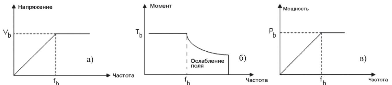
Рис. 11. Зависимости напряжения момента и мощности от частоты двигателя при управлении через преобразователь частоты
